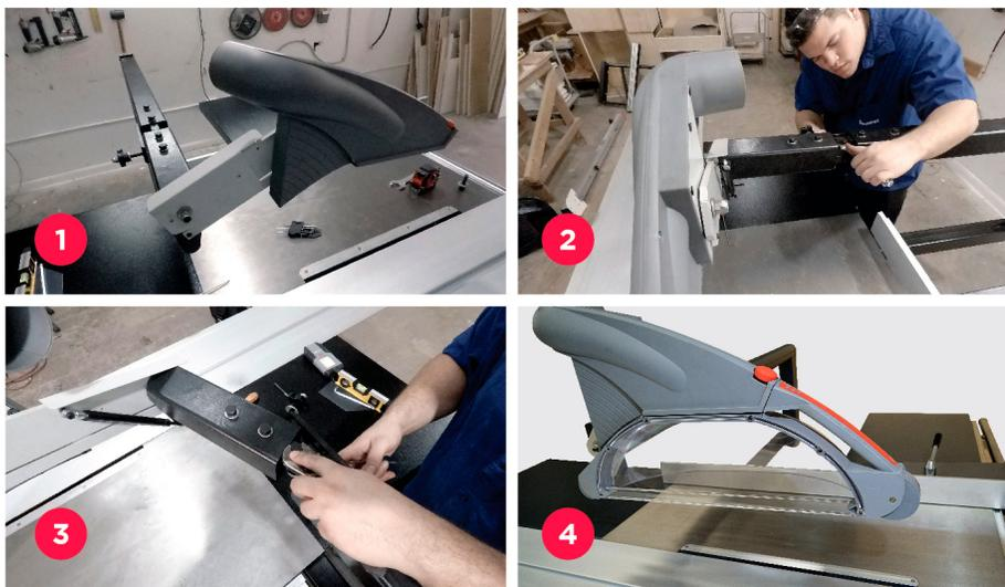
Fig. 1: Encaixe o protetor de serra na estrutura.
