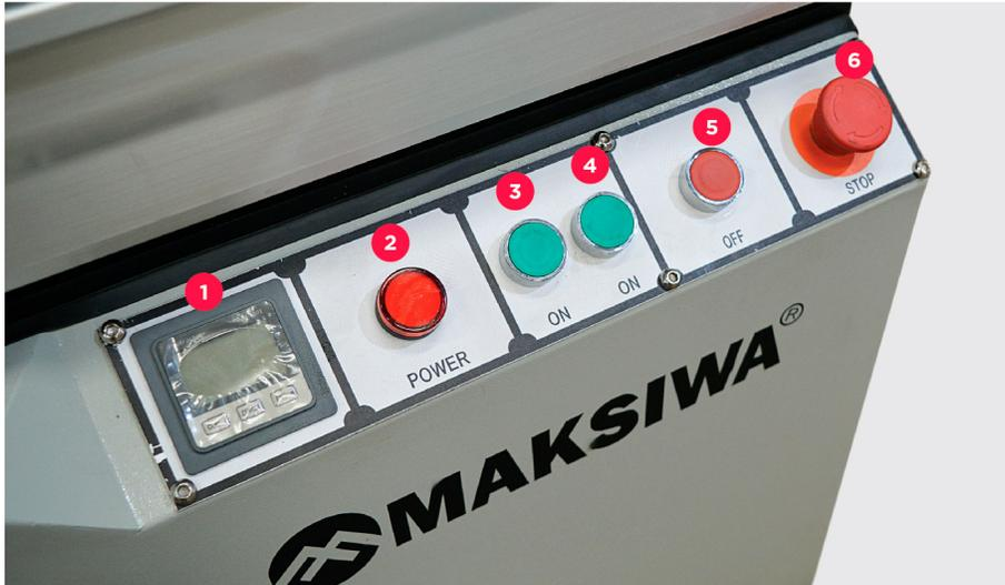
Na central de comando você controla todos os acionamentos e dispositivos de corte da máquina, salvo o sistema riscador.
