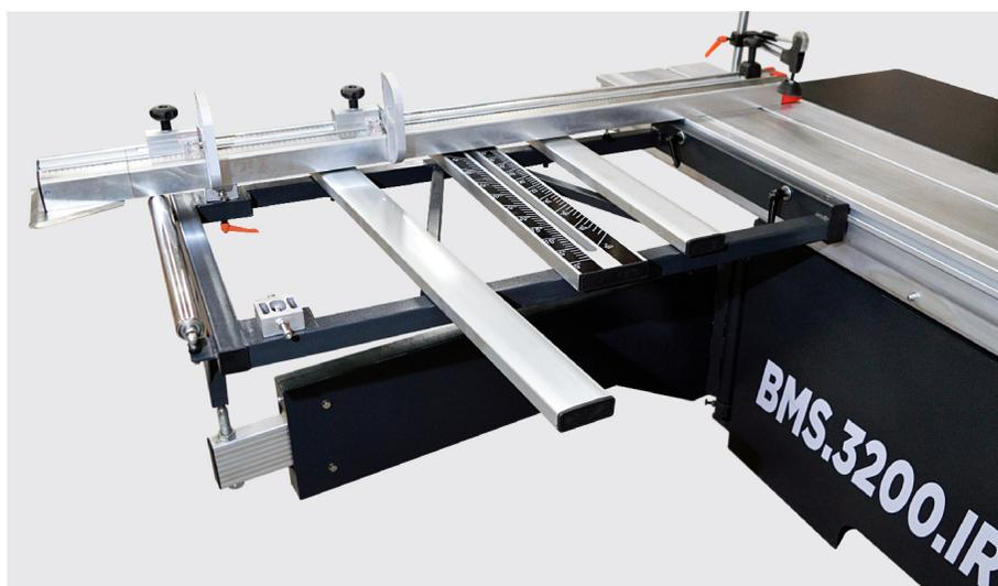
É utilizada para apoiar peças de trabalho maiores e realizar cortes transversais. Pode ser colocada em toda extensão da mesa móvel.
