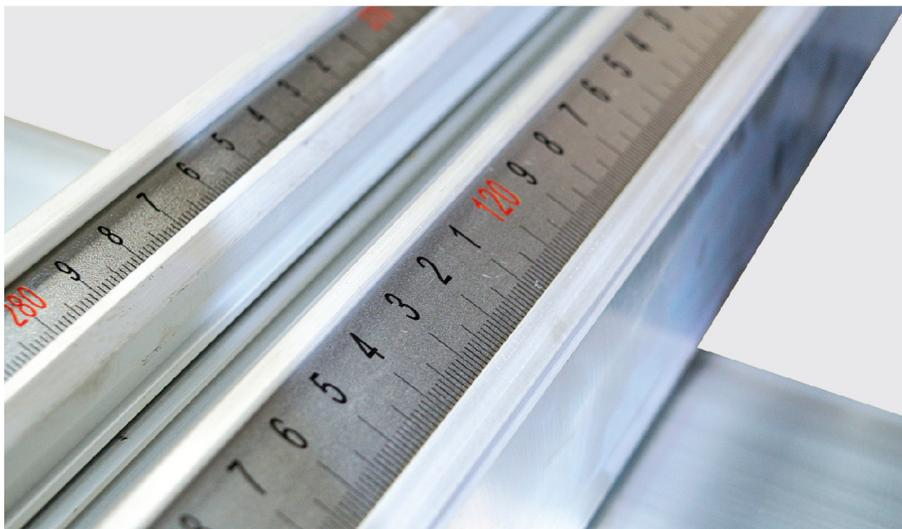
Feita em alumínio, a guia da mesa móvel tem a função de ajustar a peça de trabalho na posição que o operador desejar.
