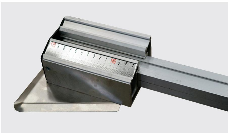
Tem a função de ampliar a área de trabalho do operador, possibilitando cortes em chapas inteiras.
