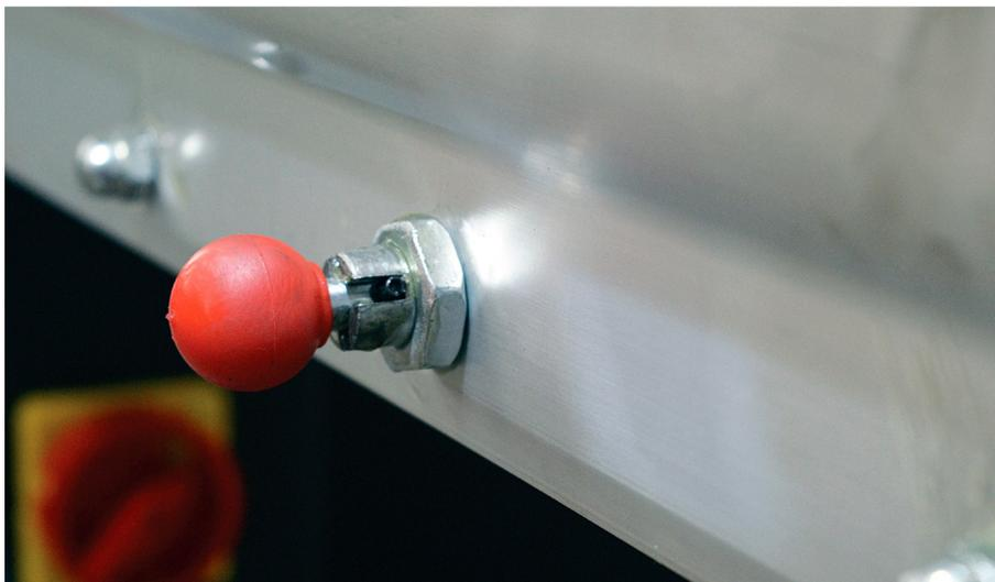
Quando acionado ele trava a mesa móvel na estrutura, quando solto ele destrava a mesa móvel.
