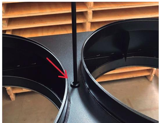
6. Para montar o Funil Coletor com 5 Saídas, aplique silicone no área ao redor do orifício principal, use as 12 peças kit de parafusos para prender o Funil Coletor no local designado (silicone não incluído):
