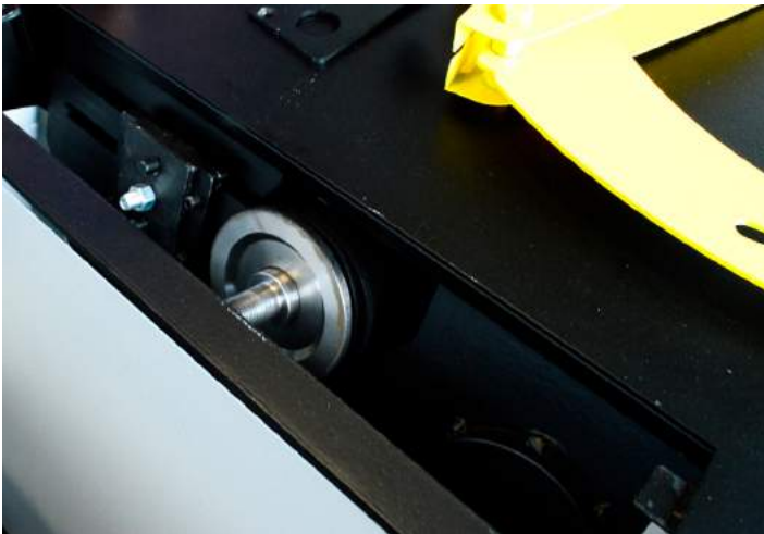
19) Instale o protetor de serra.
