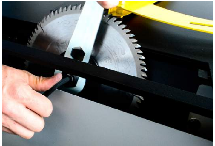
19) Instale o protetor de serra.
