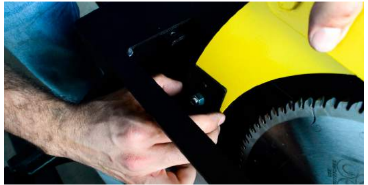
19) Instale o protetor de serra.
