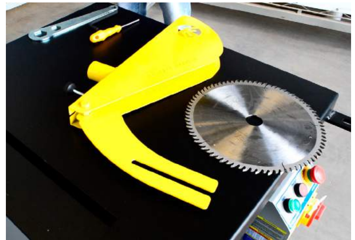
16) Retire o apoio que antecede a serra.
