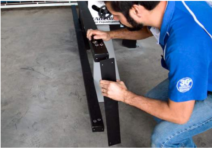
14) Instale o reforço dos varões.
