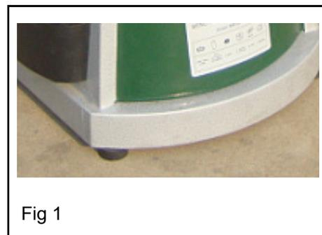
Coloque o pé emborrachado, parafuso e arruela. Aperte utilizando uma chave adequada se houver necessidade.
