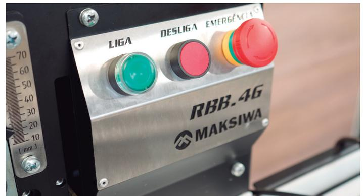
2. Ajuste a altura do avanço conforme a espessura da peça que for passar, utilizando as duas escalas laterais.
