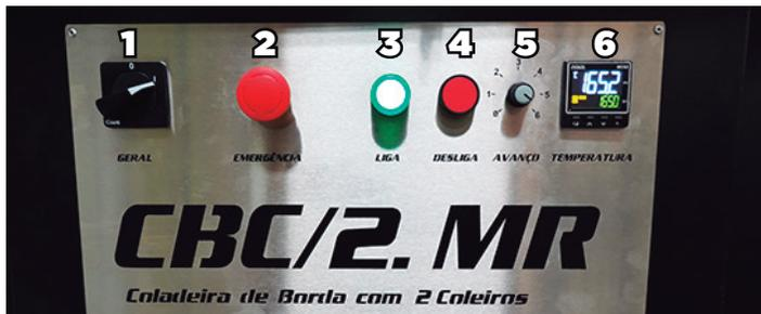
1. Ligue a chave seccionadora. Essa chave energiza o painel da máquina, porém sem ligá-la.
