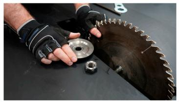
Passo 3: Recoloque a flange, a porca e aperte bem para que a serra fique firme.
