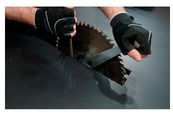
Passo 2: Retire a flange do sistema de corte e encaixe a serra escolhida. Entre a serra e o cutelo o espaçamento deve ser no mínimo de 3 mm e no máximo de 8 mm.
