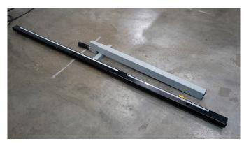
Aproveite a instalação para também já efetuar o ajuste da base da guia e da guia, utilizando uma régua para que a guia esteja paralela a serra:
