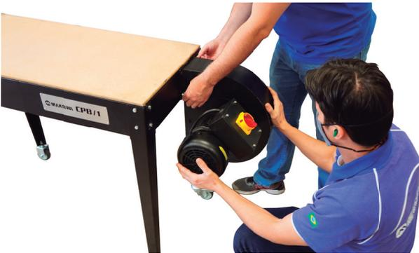
8. Após a correta instalação do motor, coloque o saco coletor no local demonstrado, utilizando a cinta de fixação:
