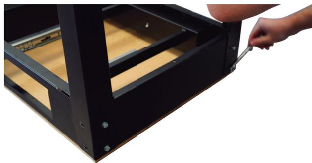
5. Lembre-se que a alça para transporte deve ser instalada na parte oposta a do motor, juntamente com as pernas, utilizando o mesmo furo:
