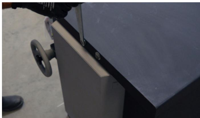
Fig.20 - Soltando os parafusos do prolongador
