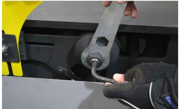
Fig.55 - Retirando a porca do sistema de corte
