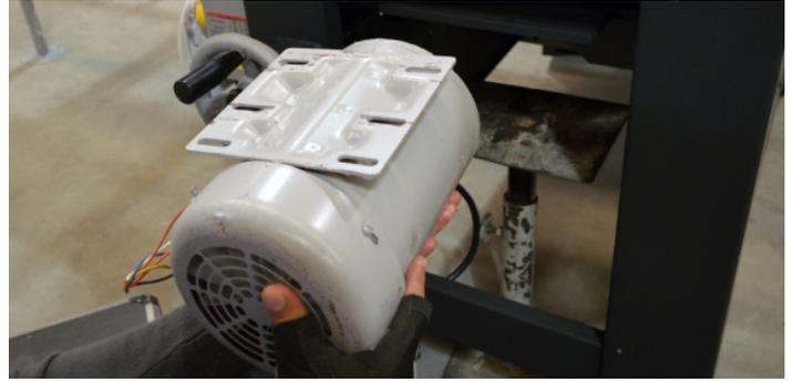
Fig.44 - Instalando o motor na base com ajuda de um suporte
