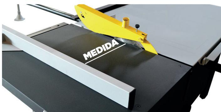
Fig.93 - Ajustando a entrada da serra
