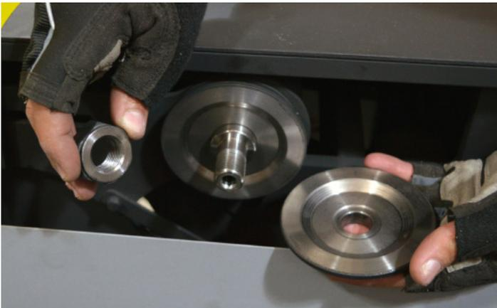
Fig.57 - Retirando a flange do sistema de corte
