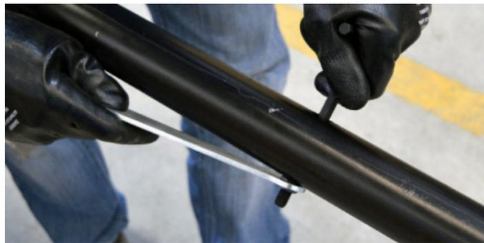
*Fig.2 - Afrouxando parafusos e retirando as porcas*
