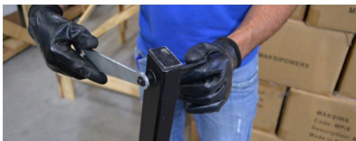
Fig.17 - Afrouxando os parafusos da guia fixa
