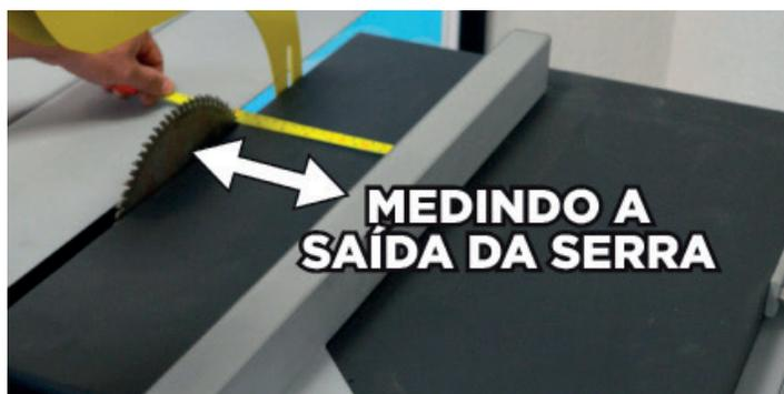
Fig.94 - Ajustando a saída da serra
