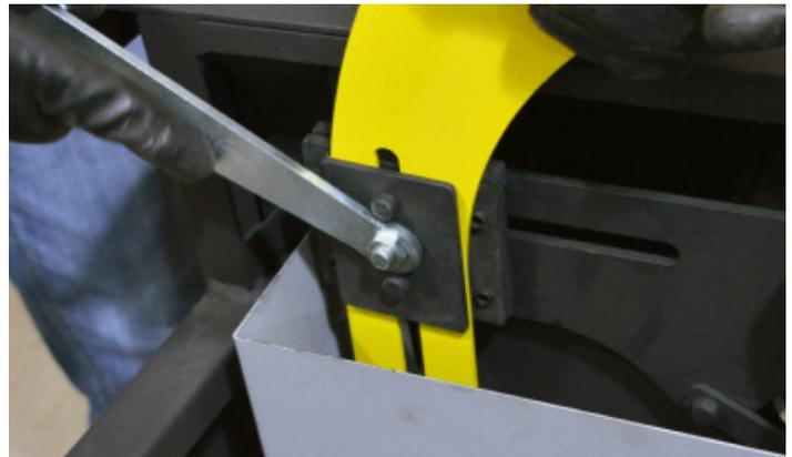
Fig.30 - Apertando o parafuso do protetor
