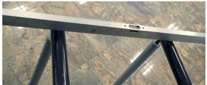
Fig.13 - Régua de nível sobre os varões
