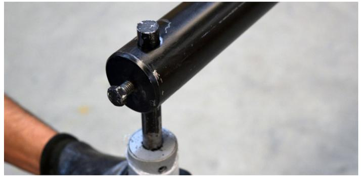
Fig.11 - Pinos levantados para travar a mesa móvel
