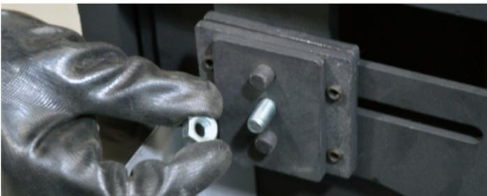
Fig.27 - Retirando a porca do sistema de protetor de serra
