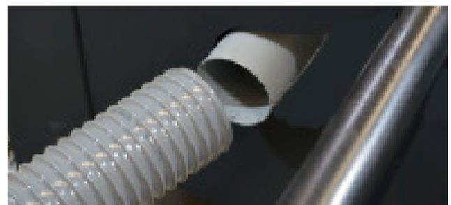
Fig.74 - Instalando a mangueira atrás da máquina
