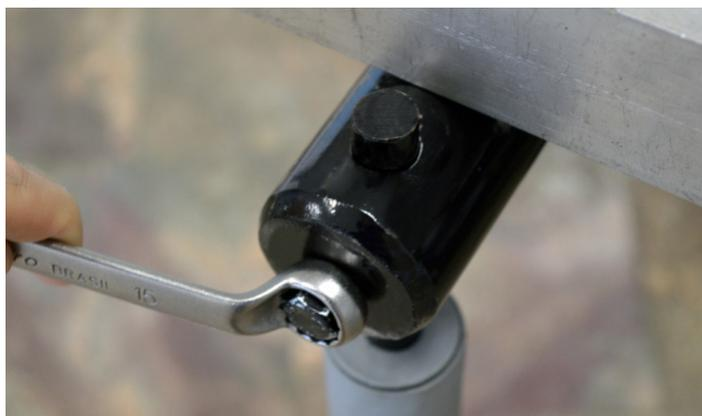
Fig.16 - Apertando os parafusos para travar o varão
