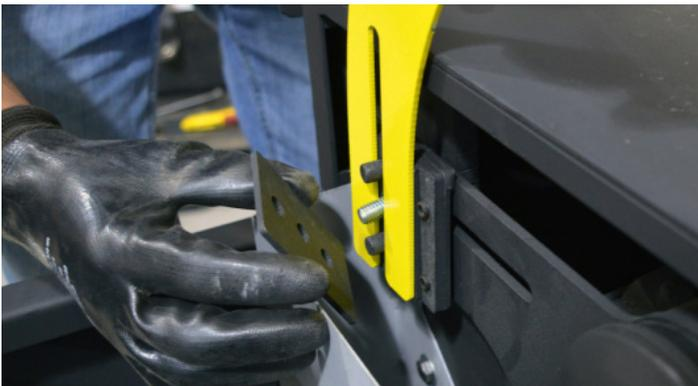
Fig.28 - Encaixando o protetor entre o parafuso e os pinos
