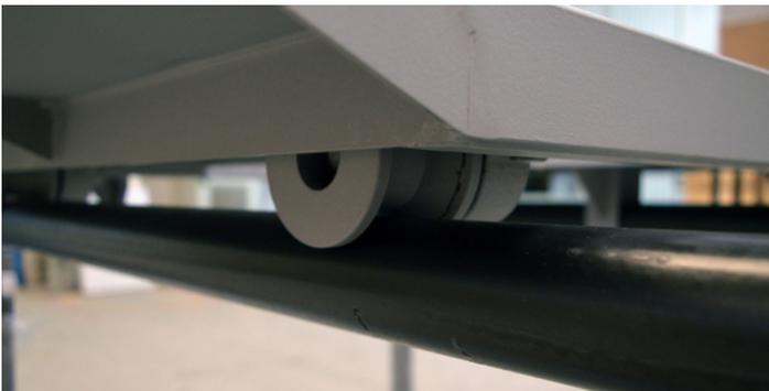
Fig.10 - Mesa móvel encaixada no varão
