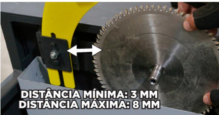
Fig.58 - Colocando a serra no sistema de corte com o espaçamento mínimo de 3 mm e máximo de 8 mm
