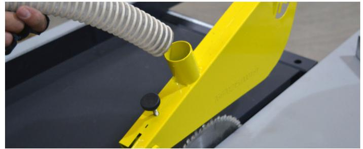
Fig.72 - Instalando a mangueira no protetor de serra
