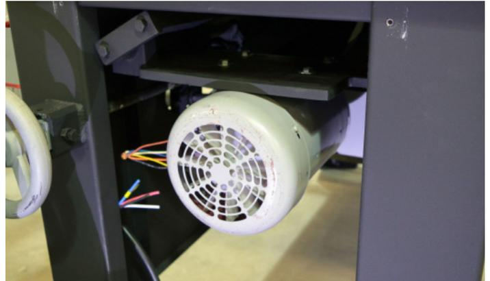
Fig.45 - Motor instalado na base
