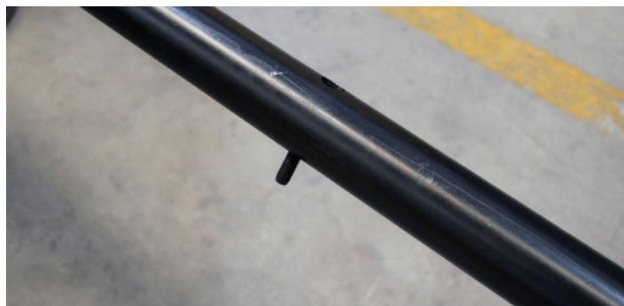
*Fig.3 - Parafuso sem a porca*
