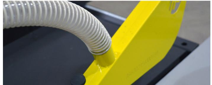
Fig.73 - Mangueira instalada no protetor de serra
