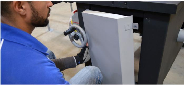
Fig.40 - Retirando a tampa protetora do motor
