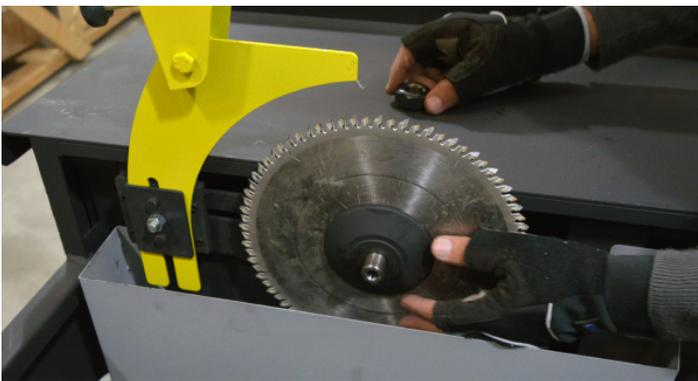
Fig.59 - Recolocando a flange
