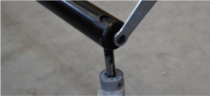
Fig.8 - Encaixando os pés e apertando o parafuso
