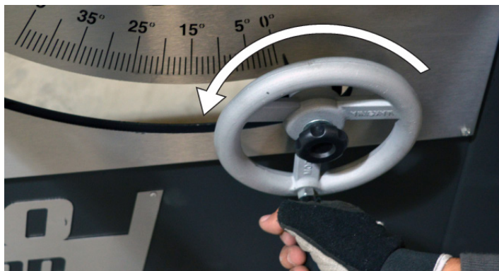
Fig.59 - Levantando a serra
