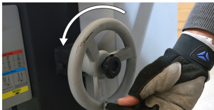
Fig.63 - Inclinando a serra
