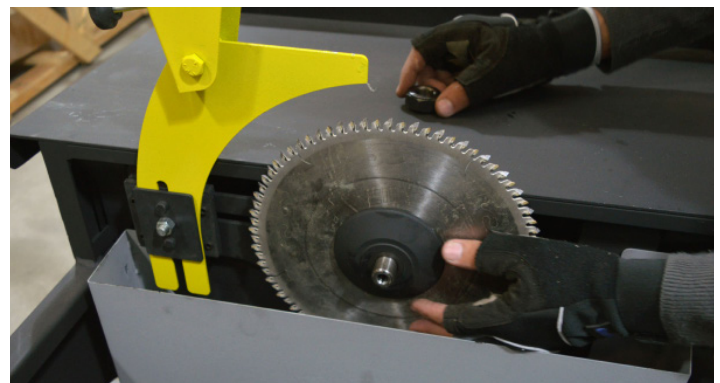
Fig.55 - Recolocando a flange
