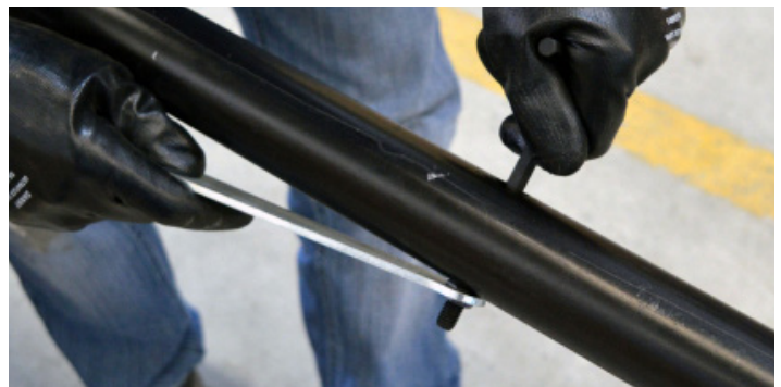
Fig.2 - Afrouxando parafusos e retirando as porcas
