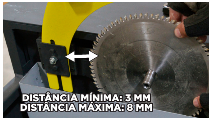
Fig.54 - Colocando a serra no sistema de corte com o espaçamento mínimo de 3 mm e máximo de 8 mm
