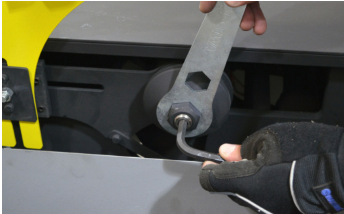
Fig.51 - Retirando a porca do sistema de corte
