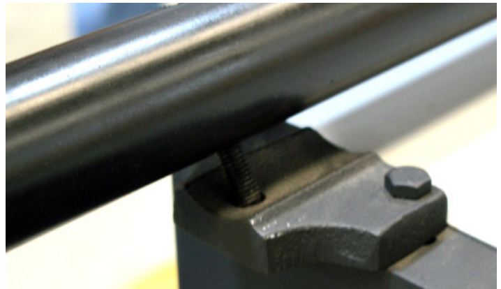
Fig.4 - Encaixando os varões na base (detalhe) e aperte os parafusos.
