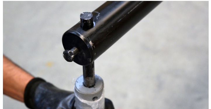
Fig.10 - Pinos levantados para travar a mesa móvel
