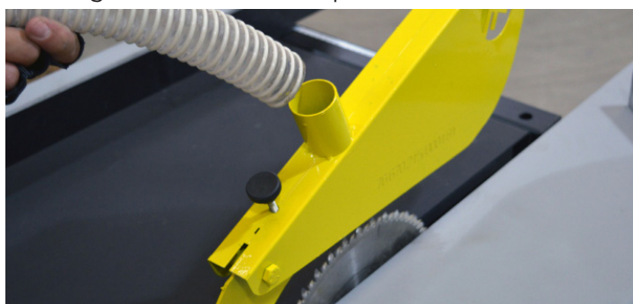
Fig.69 - Instalando a mangueira no protetor de serra
