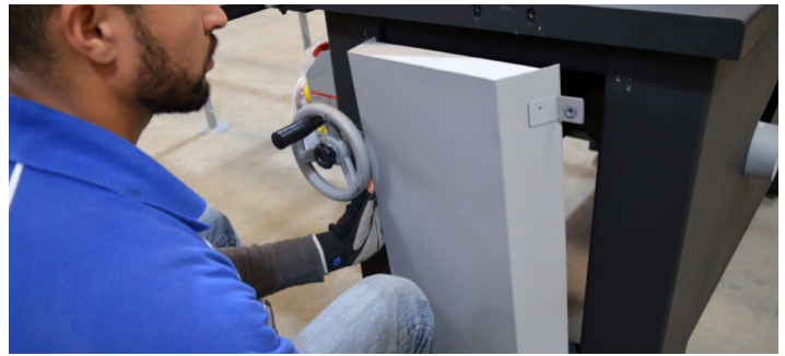
Fig.39 - Retirando a tampa protetora do motor
