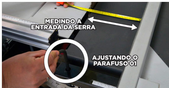
Fig.91t - Ajustando a entrada da serra
