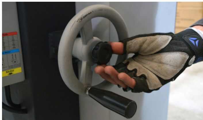
Fig.65 - Travando o volante
