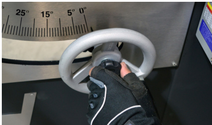
Fig.61 - Travando o volante
