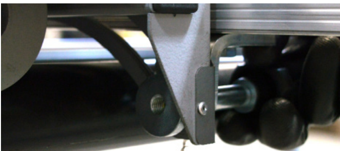
Fig.24 - Encaixando a guia em alumínio (detalhe)
