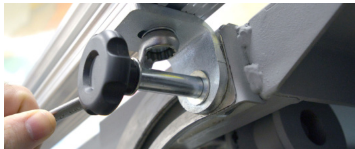
Fig.99 - Ajustando a guia em alumínio para alinhar o esquadro
