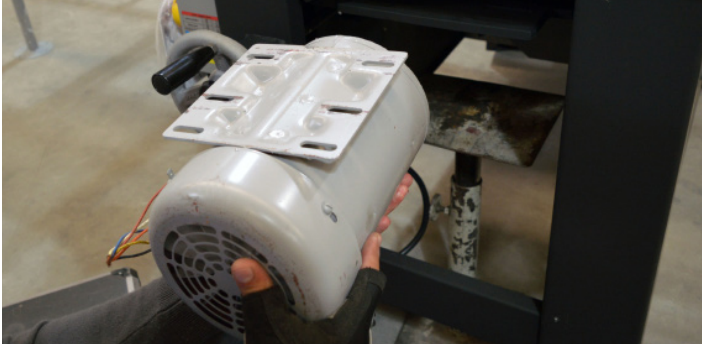
Fig.43 - Instalando o motor na base com ajuda de um suporte
