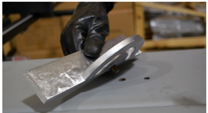
Fig.34 - Colocando a guia meia-lua na mesa móvel
