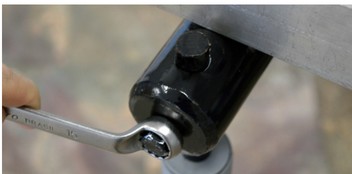
Fig.15 - Apertando os parafusos para travar o varão
