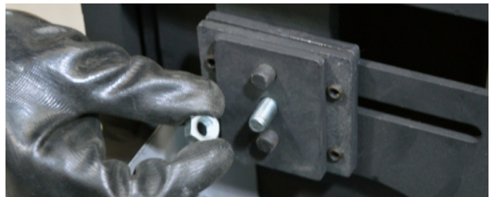
Fig.26 - Retirando a porca do sistema de protetor de serra
