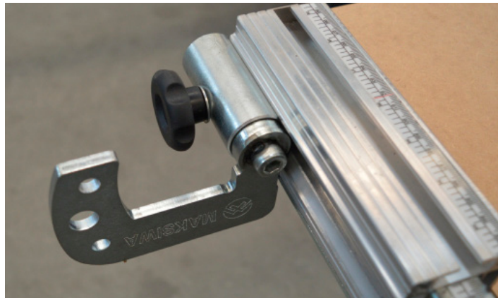
Fig.83 - Sistema stop desativado
