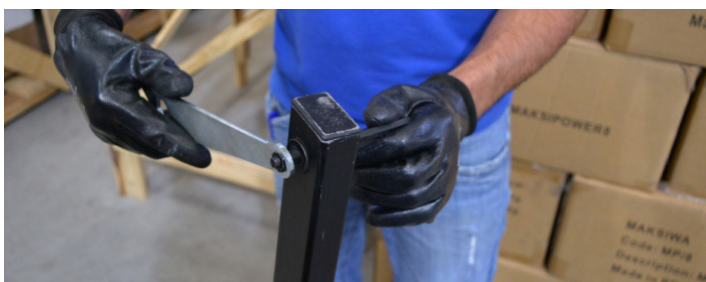
Fig.16 - Afrouxando os parafusos da guia fixa
