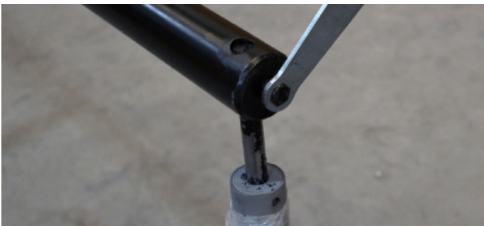
Fig.7 - Encaixando os pés e apertando o parafuso
