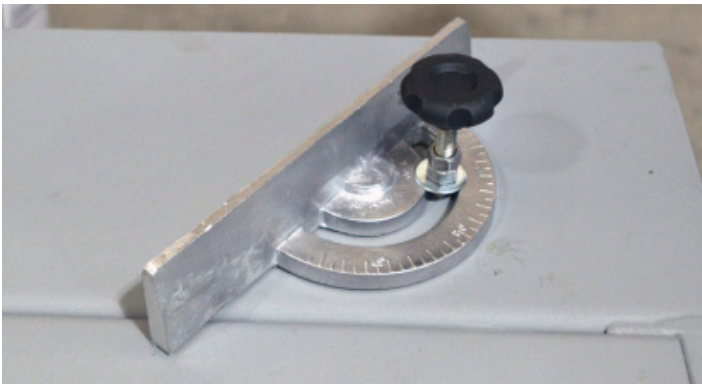
Fig.36 - Guia meia-lua instalada
