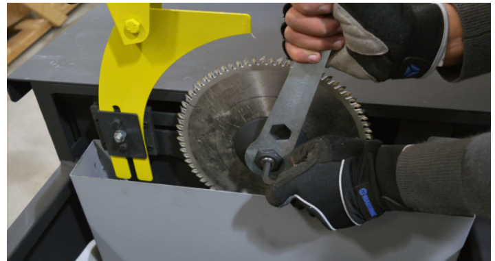
Fig.56 - Recolocando a porca e apertando-a
