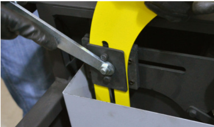
Fig.29 - Apertando o parafuso do protetor
