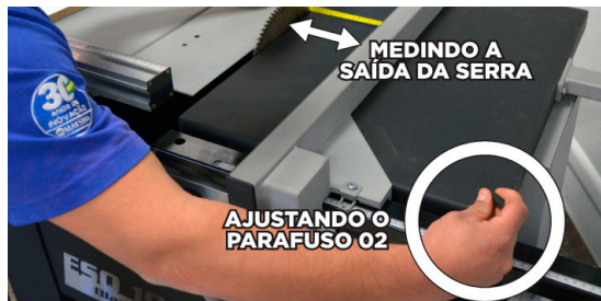
Fig.92 - Ajustando a saída da serra
