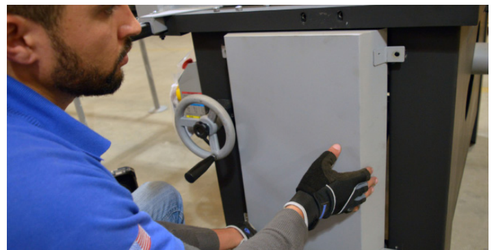
Fig.50 - Colocando a tampa protetora
