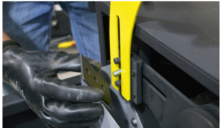
Fig.27 - Encaixando o protetor entre o parafuso e os pinos
