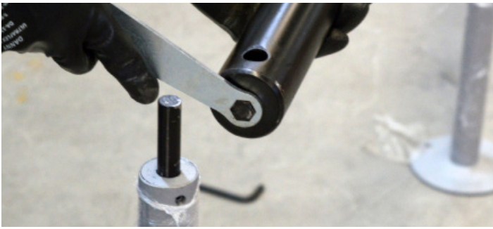
Fig.5 - Afrouxando o parafuso do varão
