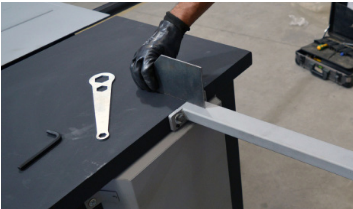
Fig.21 - Alinhando o prolongador com uma régua
