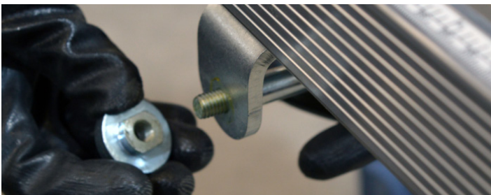
Fig.23 - Retirando a porca da guia em alumínio
