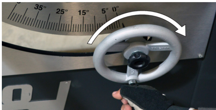
Fig.58 - Rebaixando a serra
