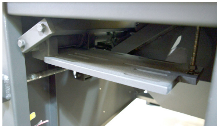
Fig.42 - Base do motor instalada
