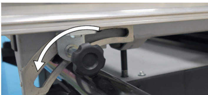
Fig.77 - Deslizando a guia para a esquerda
