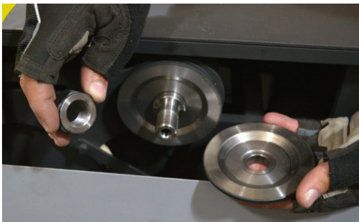
Fig.53 - Retirando a flange do sistema de corte
