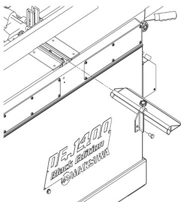
Posteriormente, instale a proteção do eixo porta facas conforme imagem a seguir:
