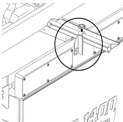
6. O equipamento possui duas alavancas de ajuste sob as mesas de trabalho. Ambas são responsáveis pelo ajuste de altura de suas respectivas mesas. Faça o ajuste necessário para que as peças passem niveladas corretamente, passando pelas facas e mesas de forma uniforme.
