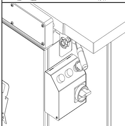
4. O painel elétrico já irá acoplado à máquina, necessitando apenas que seja feita a ligação conforme a rede elétrica. Consulte o manual do painel que está anexado ao mesmo.
