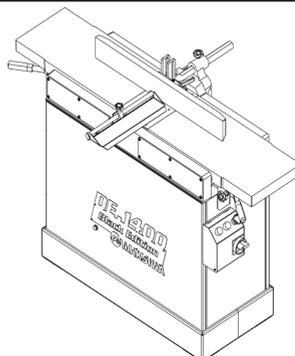
2. Instale a guia através da inserção da barra de fixação na base traseira conforme demonstrado na imagem a seguir.
