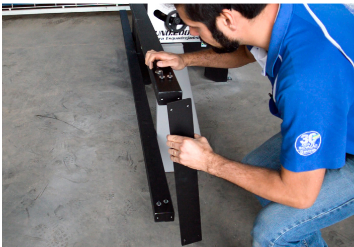
14) Instale o reforço dos varões.
