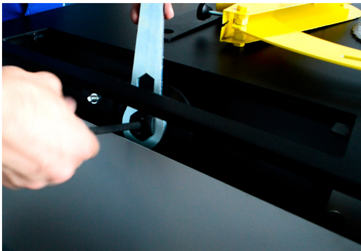
17) Retire a flange da serra
