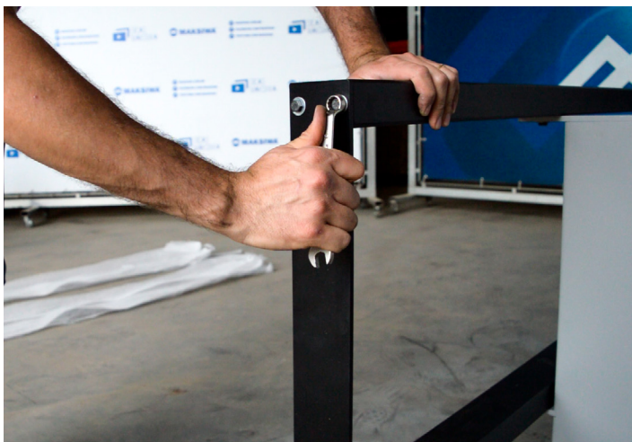
16) Retire o apoio que antecede a serra.
