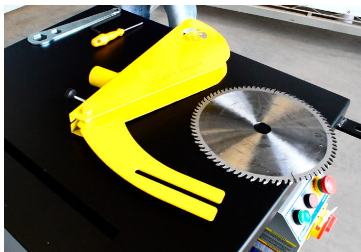
16) Retire o apoio que antecede a serra.
