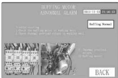
Imagem 14 - Sobrecarga de Polimento
