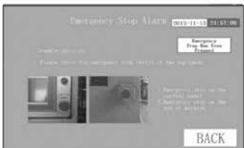
Imagem 16 - Alarme de Parada de Emergência
